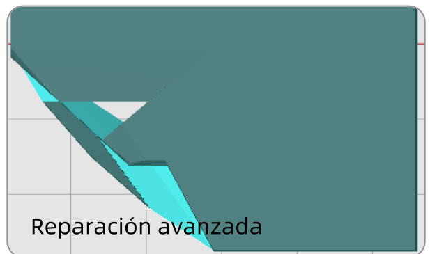
Reparación de la intersección, se agrega "no múltiple"
