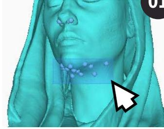
Shift+drag pour sélectionner les supports d'une zone;
