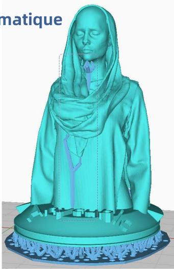
ajoutés entre la plate-forme et le modèle, entre les points du modèle
