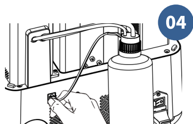
将瓶盖检测线接入 打印机背面接口
