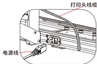
注：在插入电源线时，请避免与打印头电缆发生交叉连接，以免造成干涉。
