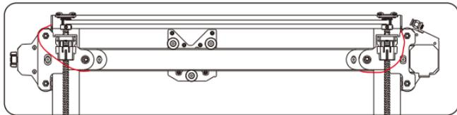
步骤2: 按照图示方向拉动皮带, 降低X轴高度。
