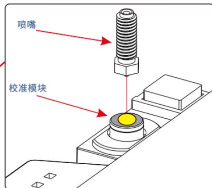
图示喷嘴为打印头上的喷嘴，为了更好的展示效果，已省略部分部件。
