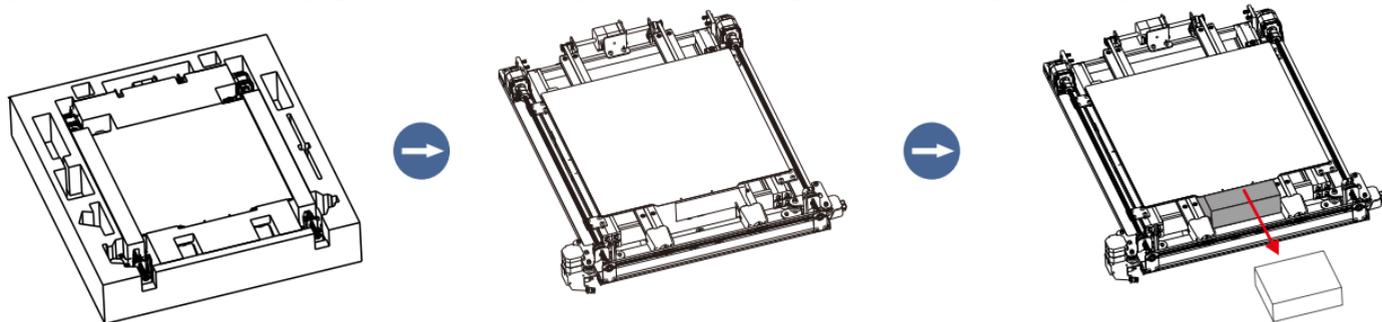
步骤2: 移除图示的4个固定板, 然后分离龙门框架和底座。
